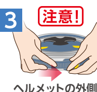
ヘルメットの外側に ヘッドバンドをロックする ※上記の状態では収納しないと ヘッドバンドが破損する恐れが あります。
